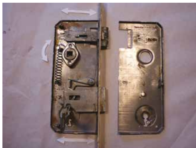
► 4. kép: mai bevéső ajtózárral, szétszedve, a működés érzékeltetésével.
