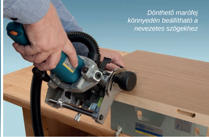
Fészek kialakítása a rögzítő elem számára a lapanyag élében
