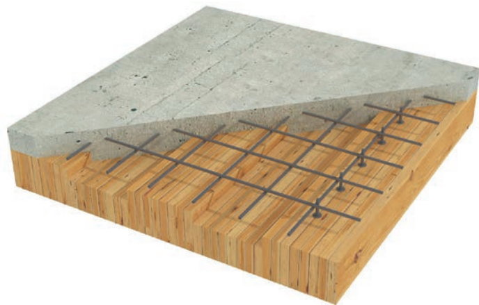
Fa-beton öszvérfödém (forrás – structurecraft.com)
