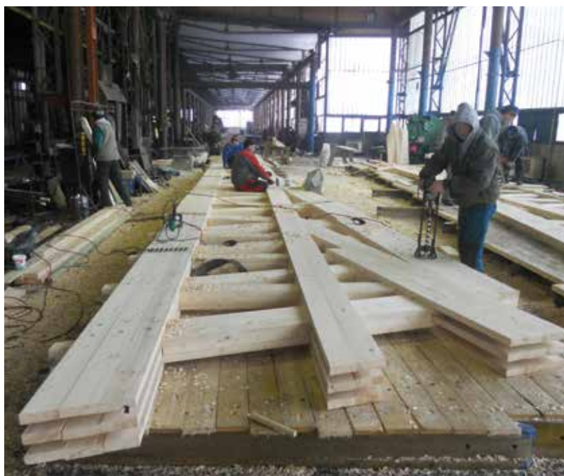
Keményfacsapos tartószerkezetek üzemi gyártása
