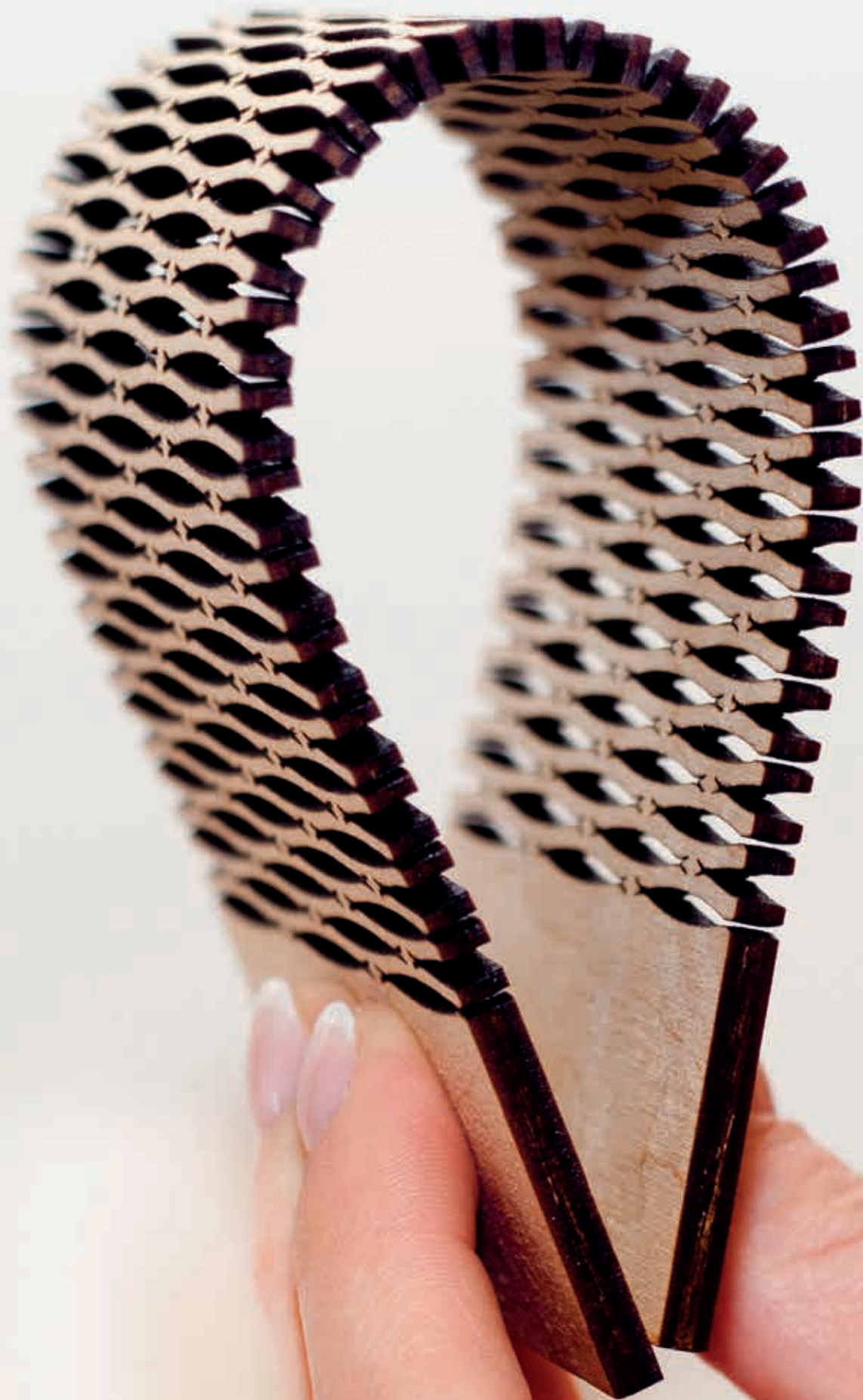
2. ábra: a saját tervezésű minta hajlítás közben
