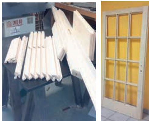
4. sz. kép: üvegajtó gyártása alkatrészekben és keretszerkezetben
