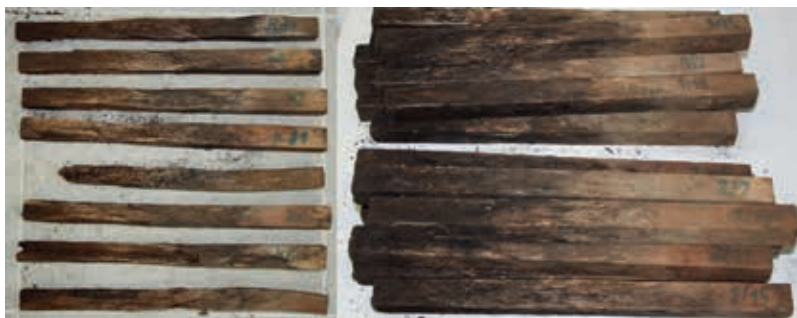
Kezeletlen (bal) és méhviasszal kezelt (jobb) cövekek 18 hónap kitettség után
