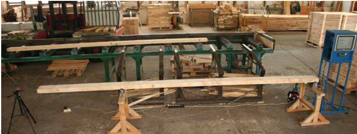
A SOE Roncsolásmentes Faanyagvizsgáló Laboratóriumában kifejlesztett PLG+ szilárdsági osztályozó berendezés
