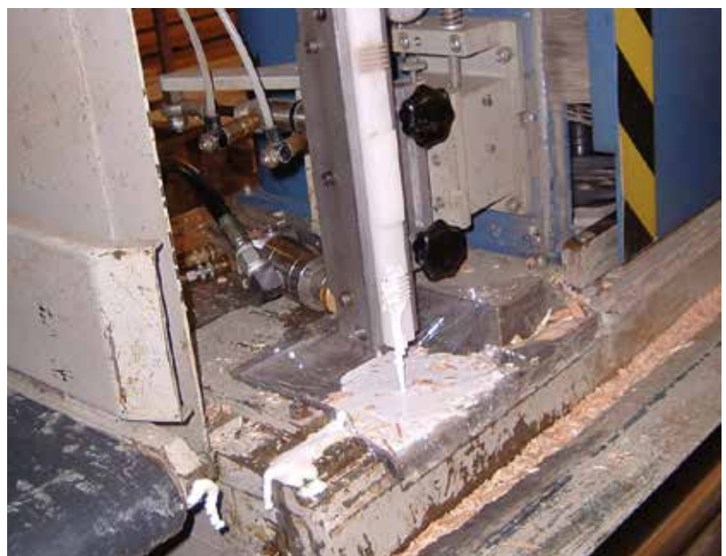
Ragasztófelhordó fej ékcsapos hosszoldáshoz.
