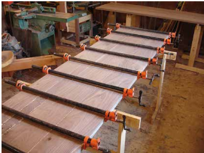
Táblásított faanyag ragasztás közben
