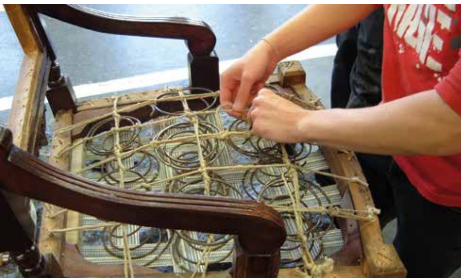
Bútorrugókból készült rugózat készül
