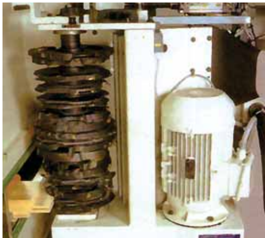
2. kép: szerszámtorony csapozó szerszámai
