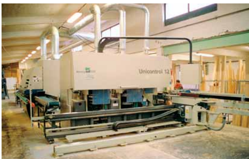
1. kép: ablakgyártó központ csapozó egysége
