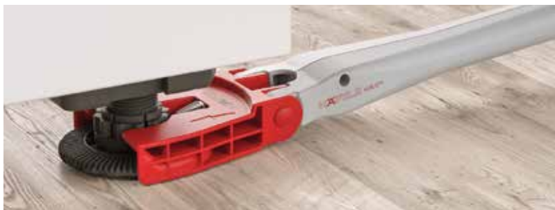
A színtező szerszámmal – AXILO™ Häfele – a szerelő egy zseniális, meghosszabbított kart kap, mellyel kényelmesen tudja színtezni a legtávolabbi színtezőlábat is
