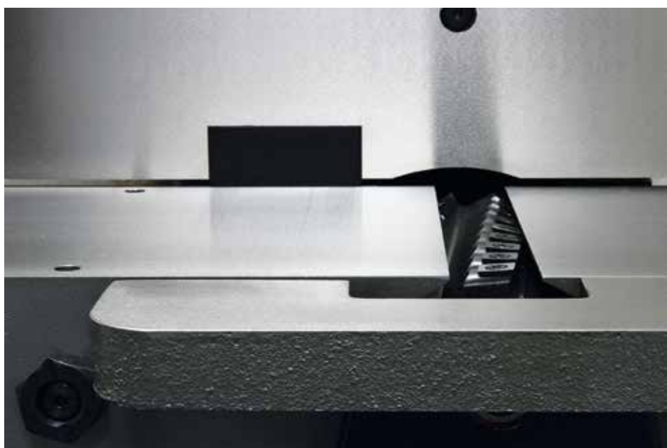
Egyengető gyalugép spirális késtengellyel
