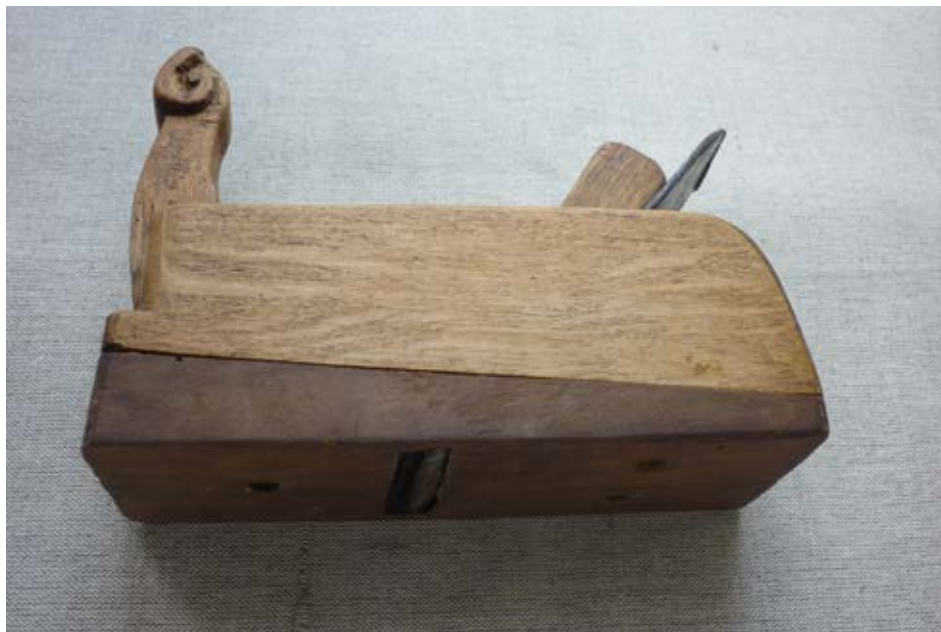
A mester saját kezével készült, majd megtalpalt simítógyalu, kiszolgált és nagyolóvá átköszörült duplalyalukéssel (17,3x6,1x13,3 cm, M.o. 19-20. sz.)
