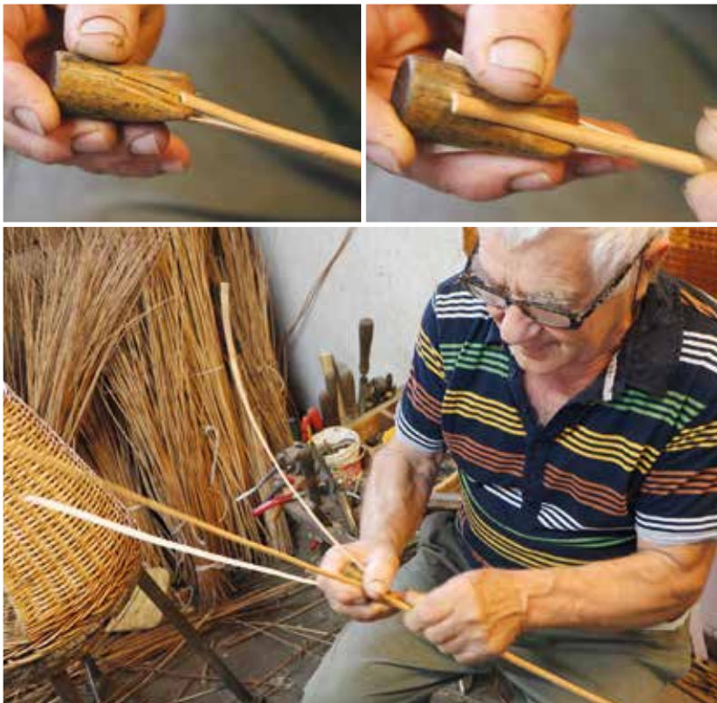
A vessző háromfelé hasítása hasítófa segítségével
