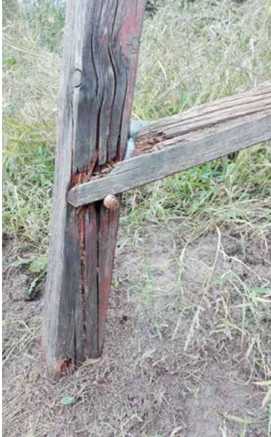
2. kép: Korhadt és repedezett balesetveszélyes hintalábak
