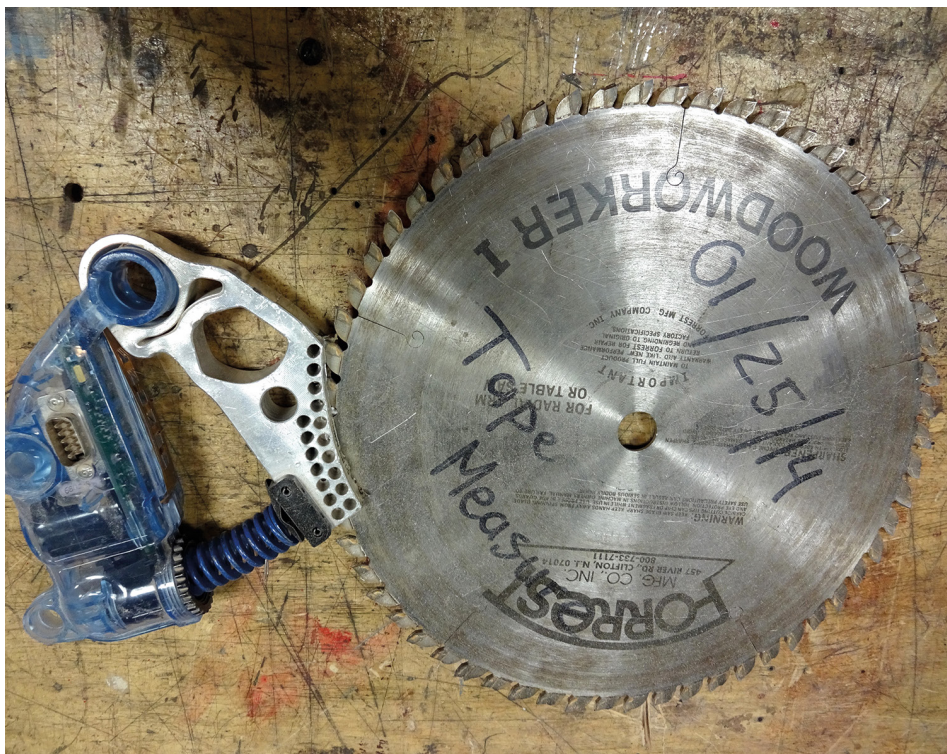
A SawStop blokkrendszere
