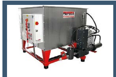
ELADÓ REINBOLD BRIKETTÁLOGÉP. Bolygatóval, előtömörítő csigával szerelt, 1,8 m 3 tárolótartállyal, teljesen automata. Ár: 1 980 000 Ft + áfa. Ár: Tajga-Depo Kft. Tel.: +36 30 953 44 57
