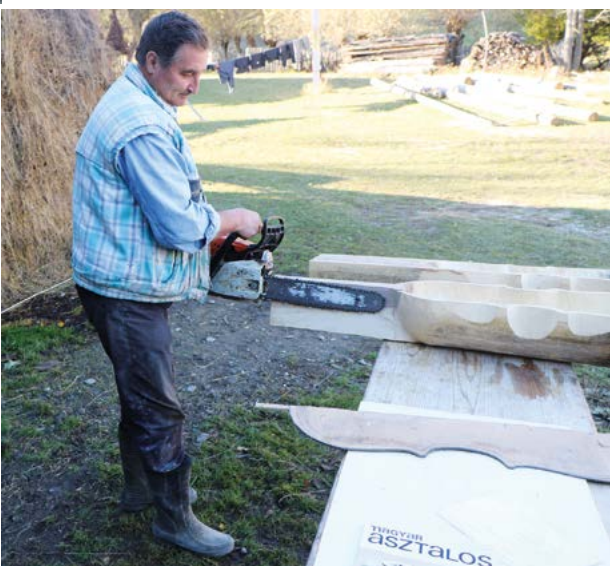
Nyak kifűrészélése láncfűrészsel
