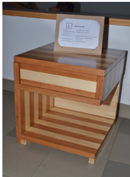
Hustiker Benedek asztalos vizsgaremeke, eltolható lapú éjjeliszekrény
