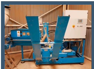
RUF 200 brikettlógép. Megtekinthető működés közben Dunaharaszti-ban. Megkímélt, jó állapotban lévő. Évjárat: 2012. Hidraulikus brikettpréss Motorteljesítmény: 11kW Kapacitás: 204 kg/óra, 240 brikett/óra (anyagfüggő) Brikett tömege: kb 0,85 kg/db Brikett mérete: 150*60*40-110 mm Üzemi nyomás: 300 bar Brikettlő mérete: 1800*1600*2000 mm Brikettlő tömege: 3200 kg. Ár: 37.000 € (~11 486 650.00 Ft). Érdeklődni: Kecskeméti Zoltán 06-30/948-8156 brikettelek@gmail.com
