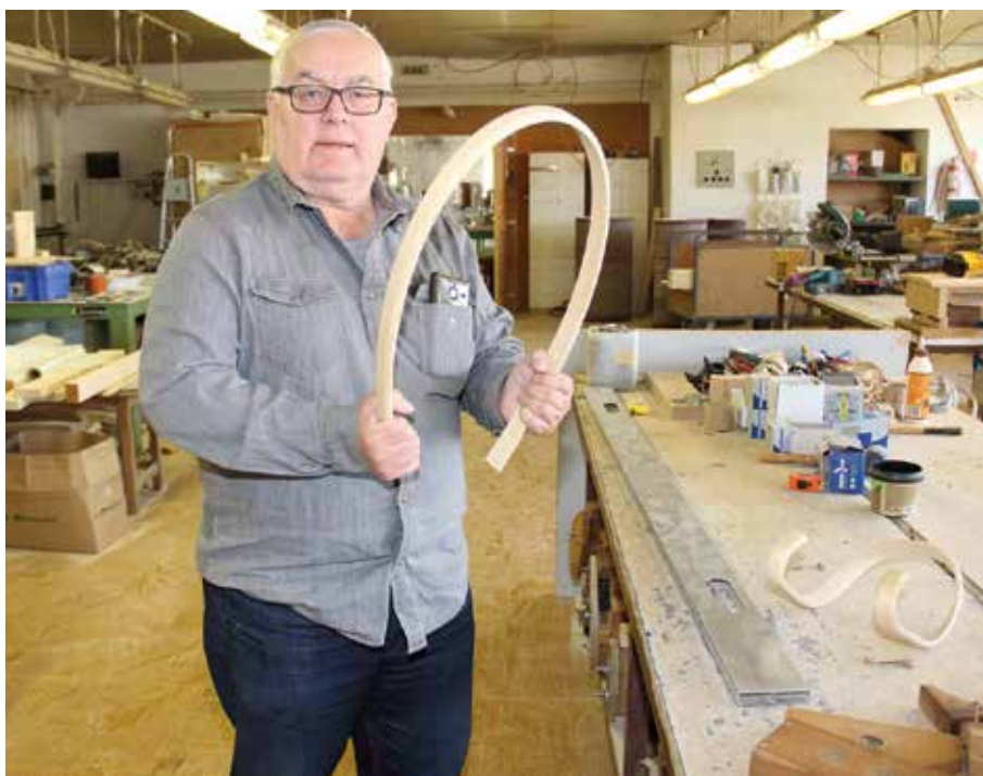
Tömörítés után a fa hidegen is hajlítható – mutatja Eckardt László
