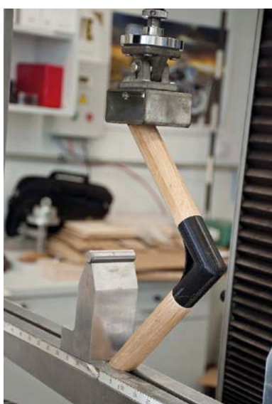
8. ábra: sarokkötés szilárdsági vizsgálata
