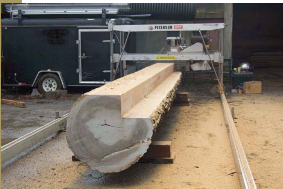
Forgató vágásra is alkalmazható a körfűrész rönkfűrészgép
