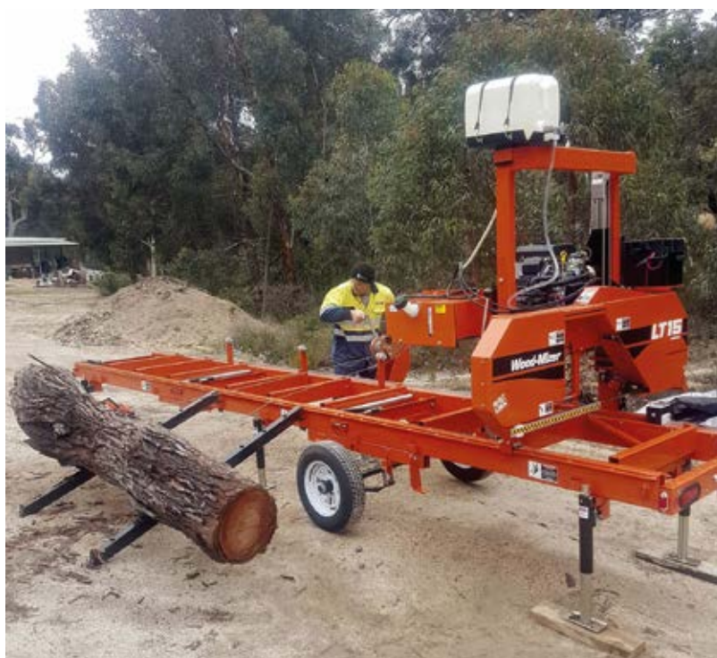
Mobil rönkfűrészegység rönkemelővel a WoodMizertől
